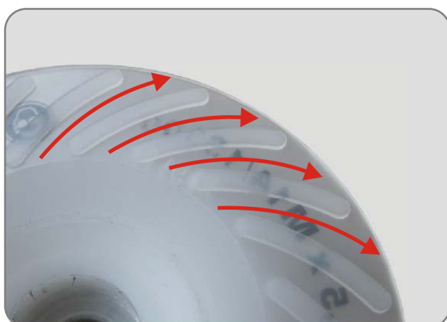
Воздухопоток во время работы тарелки
