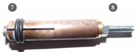
4-schlitzige Kupferbolzenaufnahme für M4 Schweißbolzen (Ø 4 mm)
