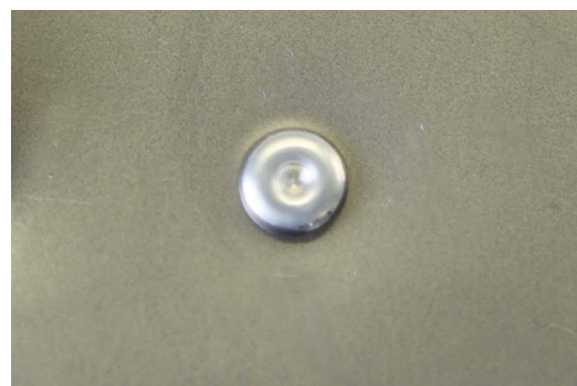
RÉSULTAT DE POSE D'UN RIVET FLOW-FORM
