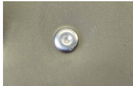
ERGEBNIS DER APPLIKATION EINES FLIESSFORM-NIETES
