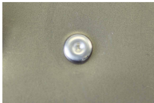
РЕЗУЛЬТАТ УСТАНОВКИ ЗАКЛЕПКИ ТЕКУЩЕЙ ФОРМЫ FLOW-FORM
