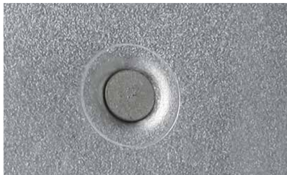
AFBEELDING PONSNAGEL VERBINDING VOOR- EN ACHTER-ZIJDE
