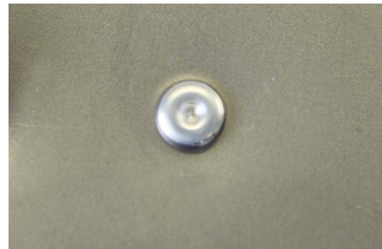
RESULTADO AL PONER UN REMACHE FLOW-FORM
