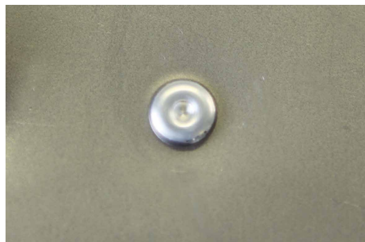
RESULTAAT VAN EEN FLOW FORM PONSNAGELVERBINDING.
