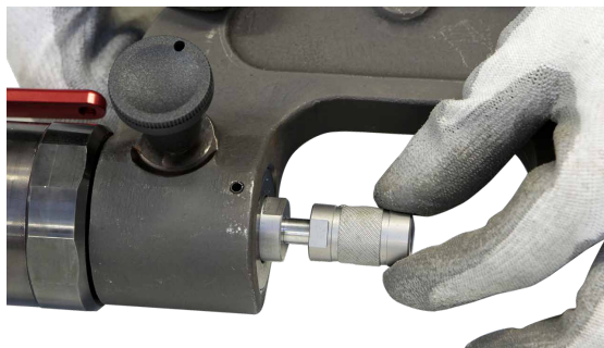
Atornillar la prolongación incluida con el brazo.
