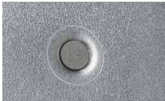
RISULTATO DELLA POSA DI UN RIVETTO AUTO-PERFORANTE
